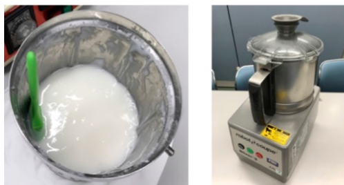
図4 高月清流米のゲルと実験で使用したせん断攪拌装置
