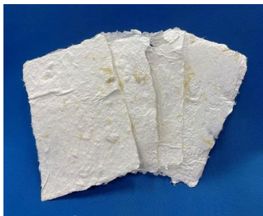
[図 1]古布を混ぜた紙の試作
