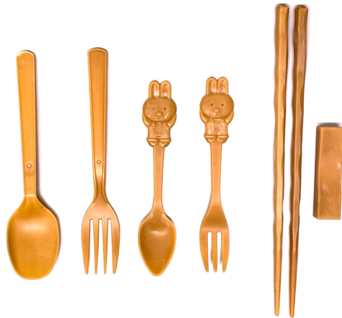
図 5. 米率 51%の米粉バイオマスプラスチック射出成型試作品
