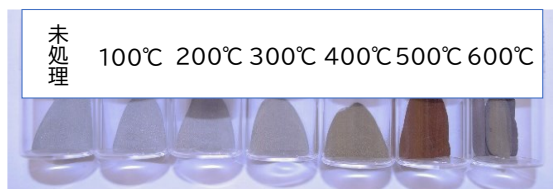
図 2. 大気中で 2 h 熱処理を施した 64 チタンの外観
