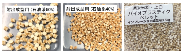
図 4. 酒米米粉から調製したバイオプラスチック素材(ペレット)
