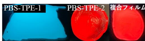
Fig. 4 紫外光照射時 (365 nm) におけるそれぞれのフィルムの写真
